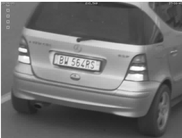
Figura 1. Nelle precedenti figure e' possibile vedere il risultato dell'applicazione della trasformazione su un esempio di immagini catturate dalla telecamera. E' da notare che la trasformazione non sempre rende la targa perfettamente orizzontale, perche' i parametri sono basati su una sorta di analisi statistica; in ogni caso, l'aggiustamento dell'immagine e' tale da permettere l'approssimazione della targa con un rettangolo di dimensioni prestabilite.
