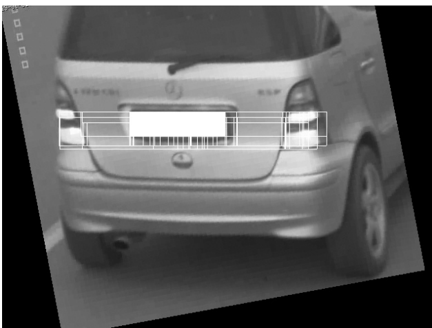
Figura 2. A sinistra è possibile notare i rettangoli candidati ottenuti applicando l'algoritmo(2). A destra viene visualizzata l'area selezionata che farà parte della maschera binaria utilizzata poi nell'algoritmo(1)
