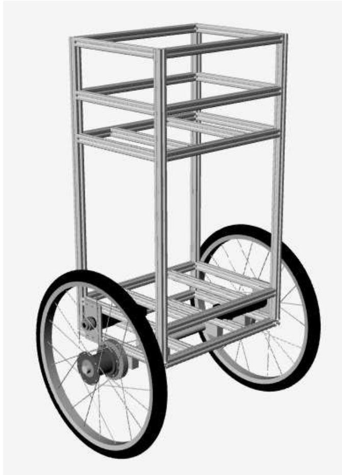
*Figura 3.1: Rappresentazione della struttura meccanica del robot.*
