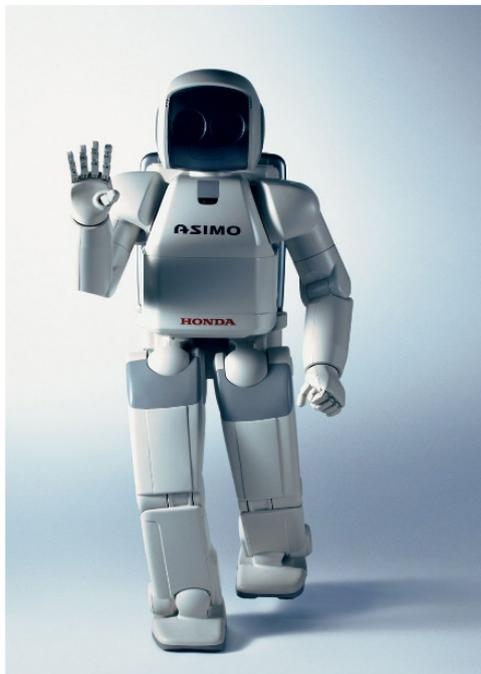
*Figura 2.1: Honda Asimo (2000) - Robot antropomorfo a camminata statica.*
