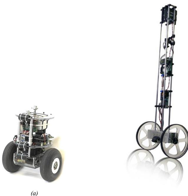
Figura 2.5: Robot bilancianti realizzati per lo studio di controllori classici: (a) nBot, 2001 (b) Balbot, 2005.
