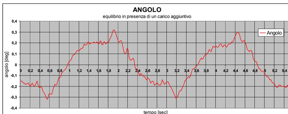
Figura 6.15: Inclinazione del pendolo misurata durante il funzionamento del robot in presenza di disturbi parametrici con setpoint di velocità nullo.
