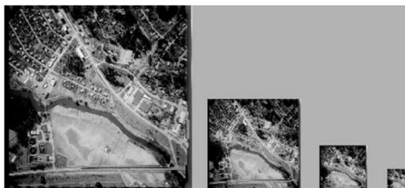
Figura 3.7: Rappresentazione piramidale a quattro livelli di una ripresa aerea
