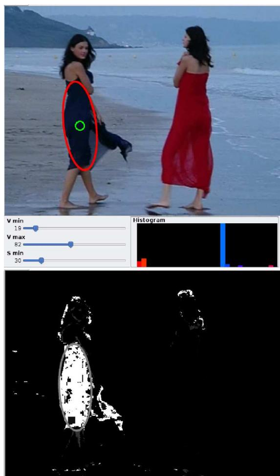
Figura 4.3: Esempio di immagine prima e dopo il calcolo del frame di “backprojection” corredata da istogramma colore e soglie di filtraggio  $S$  e  $V$
