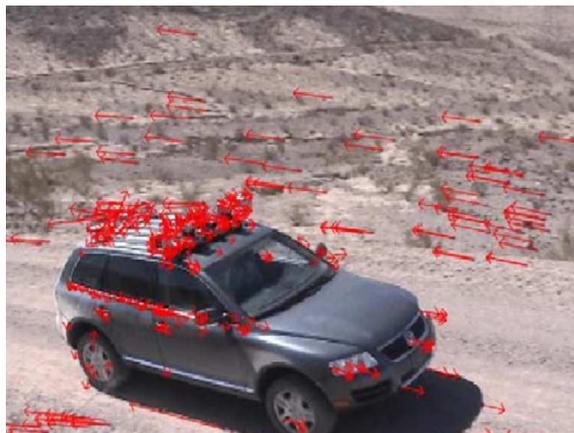
*Figura 3.5: Un esempio di calcolo del flusso ottico per alcuni corner in un'immagine in movimento*
