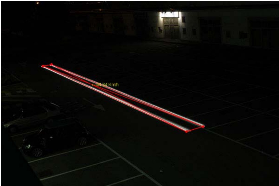
Figura 23: Immagine gps43Kmh-2.5sec.jpg (velocità veicolo: ~43Km/h, velocità rilevata: 44.84Km/h, esposizione: 2.5s)
