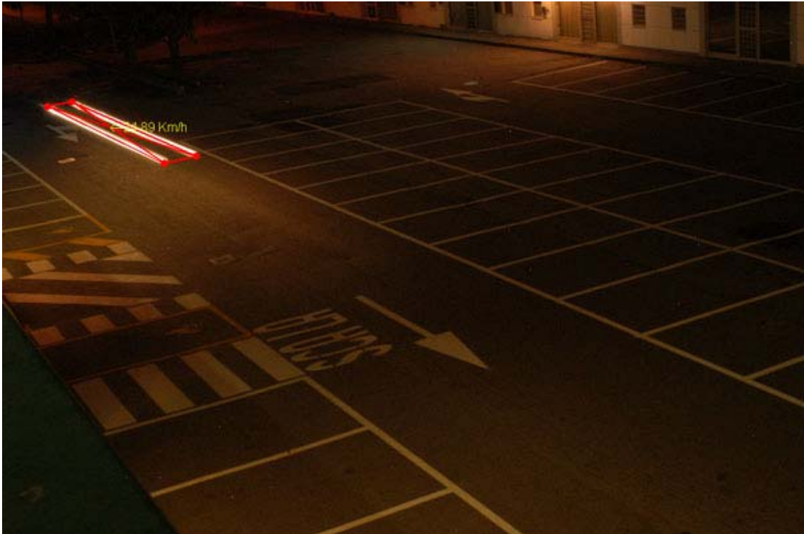
Figura 16: Immagine 25Kmh-2.5sec.jpg (velocità veicolo: ~25Km/h, velocità rilevata: 24.89Km/h, esposizione: 2.5s)
