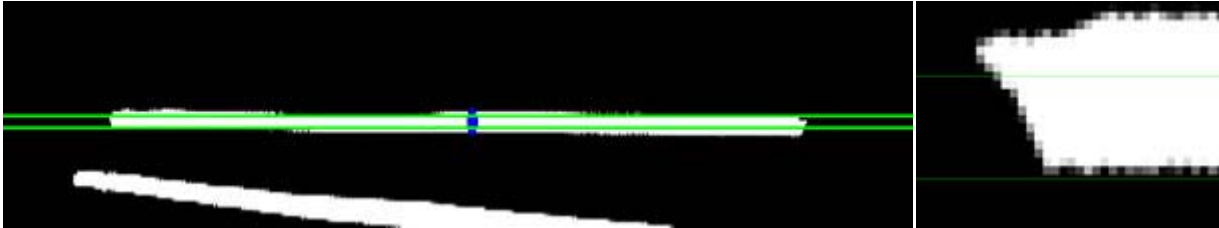
Figura 7: Striscia ruotata e relativa selezione (immagine binaria dopo threshold)
