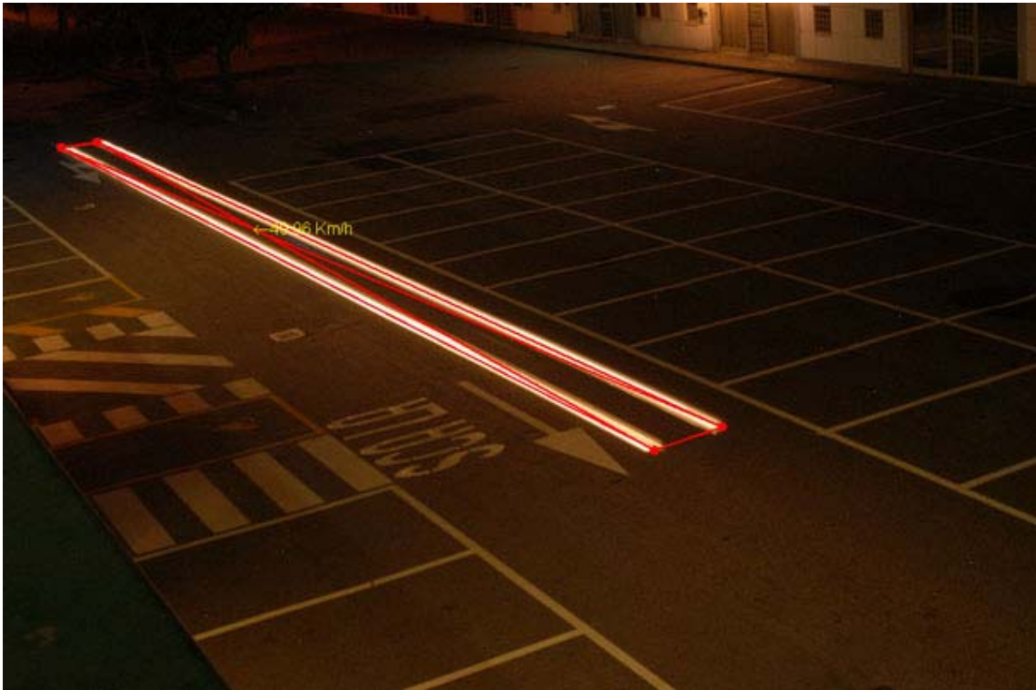
Figura 18: Immagine 50Kmh-2.5sec.jpg (velocità veicolo: ~50Km/h, velocità rilevata: 49.96Km/h, esposizione: 2.5s)
