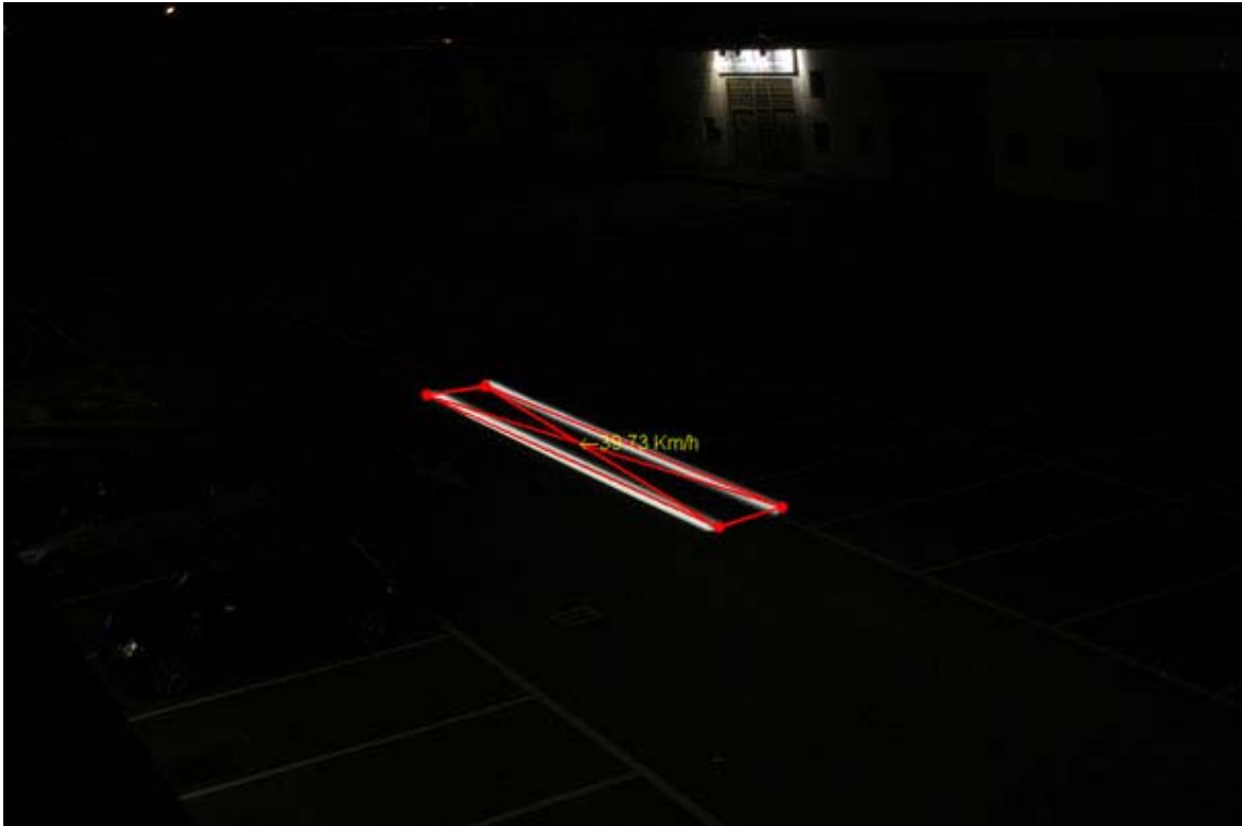
Figura 19: Immagine gps37Kmh-1sec.jpg (velocità veicolo: ~37Km/h, velocità rilevata: 39.73Km/h, esposizione: 1s)
