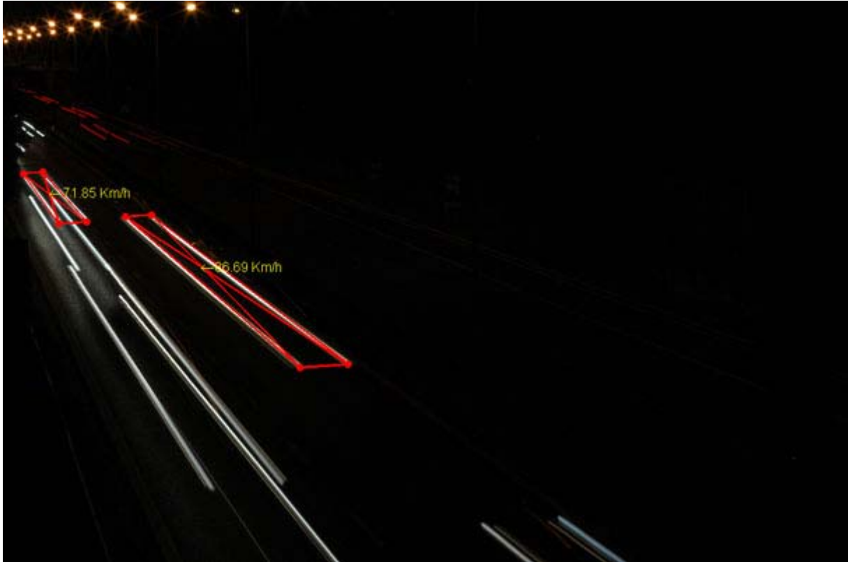
Figura 29: Esempio di rilevamento compromesso a causa della sovrapposizione delle tracce
