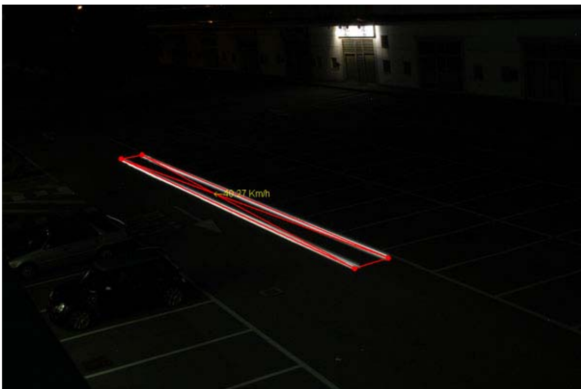
Figura 22: Immagine gps38Kmh-2sec.jpg (velocità veicolo: ~38Km/h, velocità rilevata: 40.27Km/h, esposizione: 2s)
