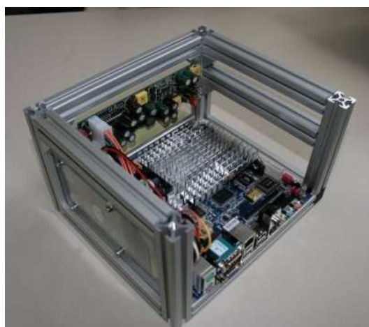
Figura 4.10: Il computer di bordo "PCBrick", montato in una struttura in profilati di alluminio
