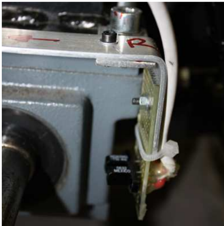
Figura 6.6: Particolare della piattina di sostegno dell'encoder a forcella
