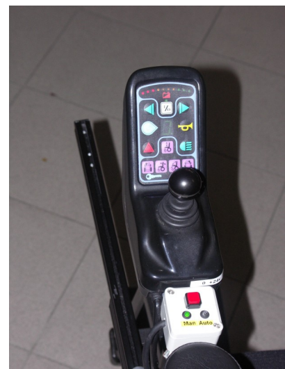
Illustrazione 2: Il joystick della carrozzina e il pulsante per il cambio della modalità di funzionamento del circuito con i due led di segnalazione
