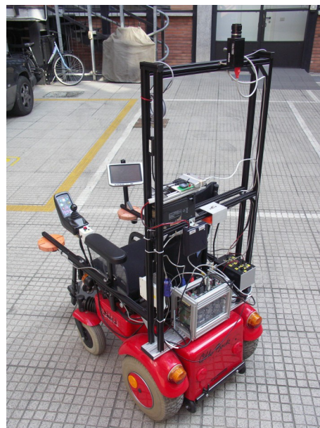
Illustrazione 3: La carrozzina Rabbit equipaggiata con tutti i dispositivi e sensori utilizzati
