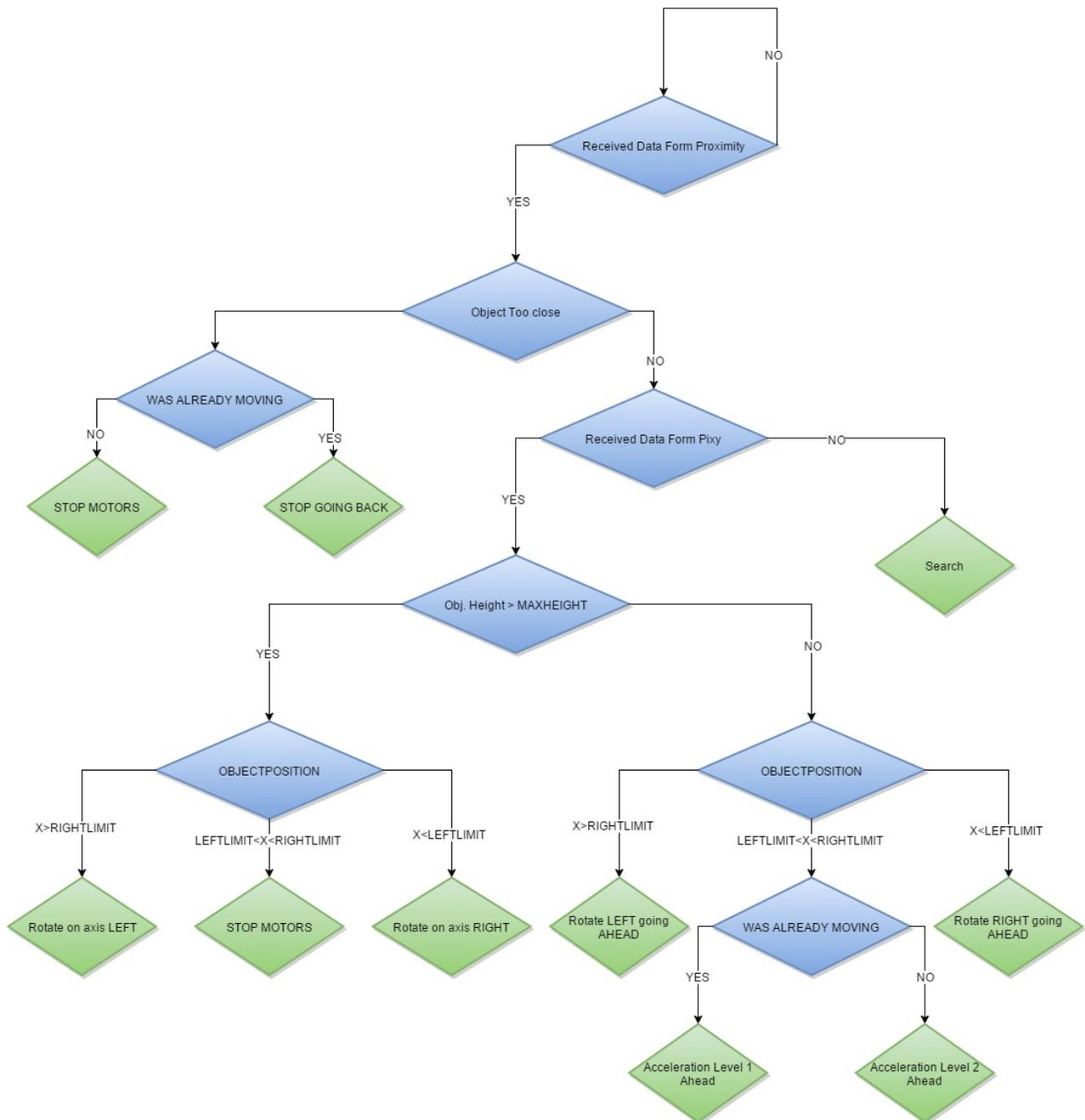
Il robot controlla se i sensori (nel nostro caso solo il sensore anteriore) rilevano un ostacolo e se è questo il caso i motori vengono fermati. Per diminuire il tempo di frenata del robot è stato implementato un controllo che verifica se il robot si sta muovendo quando l'ostacolo viene rilevato e nel caso imposta un set-point negativo per i motori.
