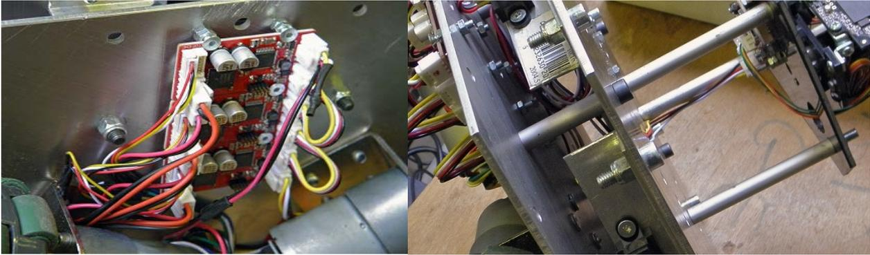
Per rendere più facile la realizzazione e la modifica del robot i livelli sono stati distanziati con un sistema a vite e bullone autobloccante e dei distanziali in alluminio. In maniera simile le schede sono state fissate alle basi con dei distanziali e fissate con dei bulloni, sfruttando le guide per le viti presenti sulle schede stesse.
