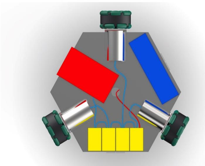
La piastra metallica ha un lato di 15cm e forma esagonale. A 3 lati dell'esagono sono fissate le ruote di 7cm di diametro con attacchi ad L di 4 cm. I motori cilindrici occupano circa 6,5 cm della base. Le 3 zone create dai motori sono occupate da:
