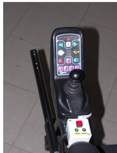
Illustrazione 1: Il joystick della carrozzina e il pulsante per il cambio della modalità di funzionamento del circuito con i due led di segnalazione
