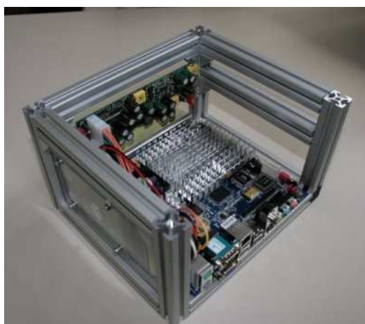
Figura 4.5: Il computer di bordo "PCBrick", montato in una struttura in profilati di alluminio
