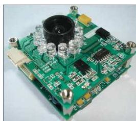
Figura 3.5: Il proiettore ad infrarossi e la telecamera di StarGazer
