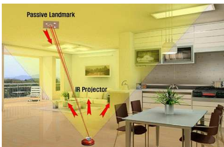
Figura 3.5: Il proiettore ad infrarossi e la telecamera di StarGazer
