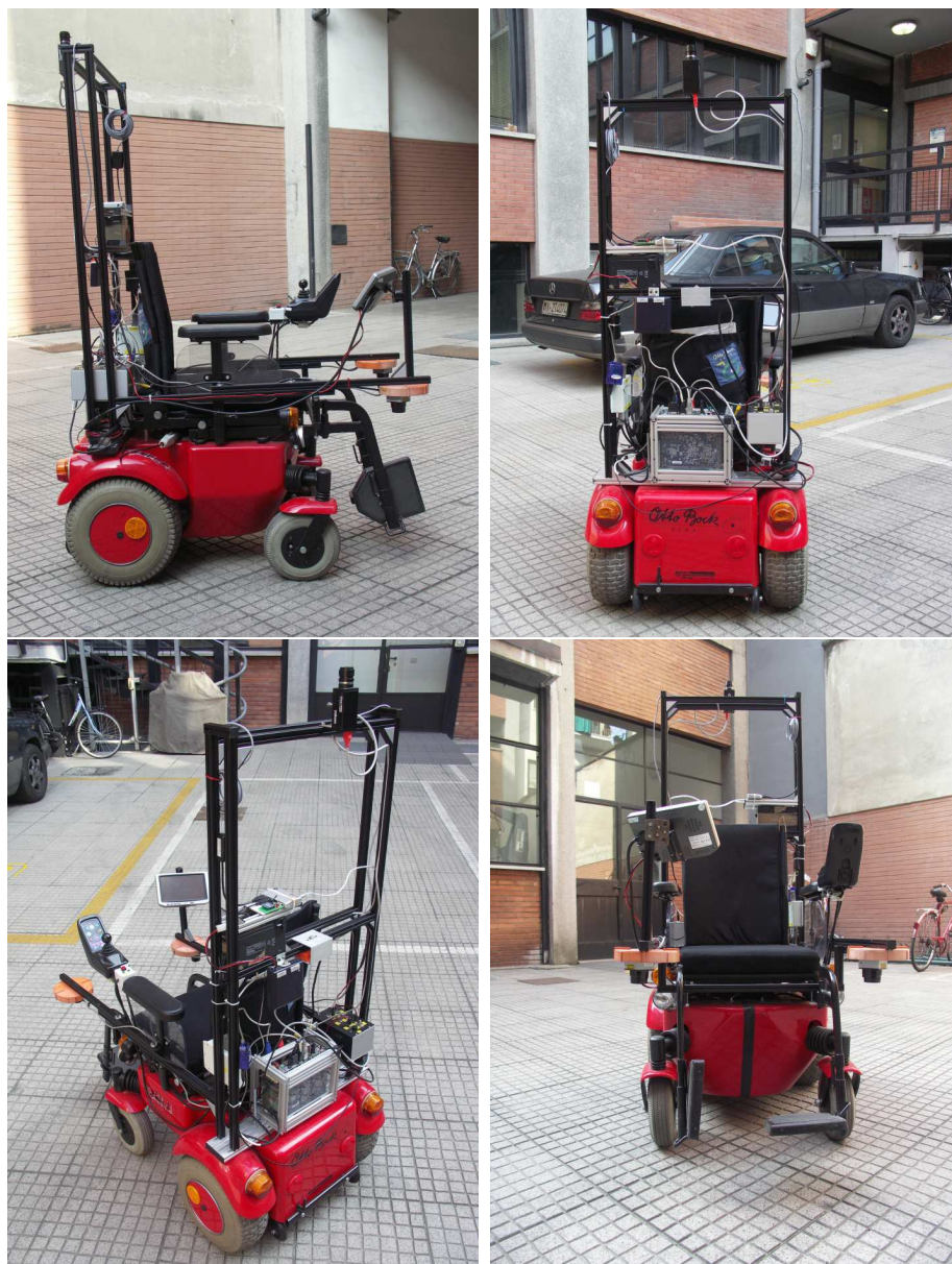
Figura 7.1: La carrozzina elettrica Rabbit con la struttura di supporto e tutti i componenti aggiunti
