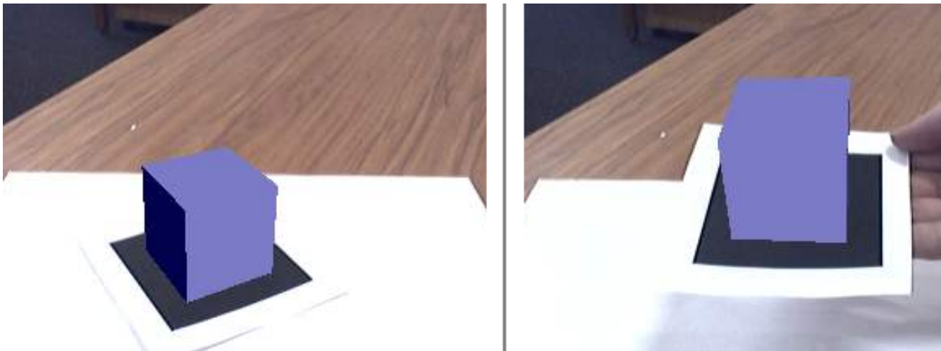
Figura 2.12: ArToolKit disegna l'oggetto tridimensionale (un cubo) nella stessa posizione ed orientamento del marker.
