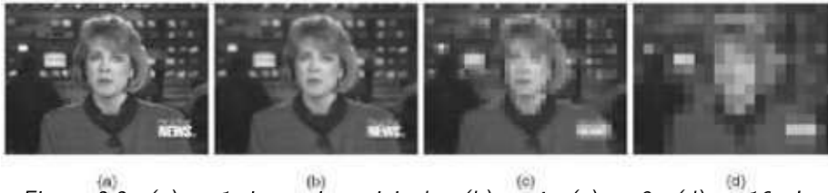
Figura 2.2: (a) n=1 , immagine originale. (b) n=4 . (c) n=8 . (d) n=16 . Immagine originale a bassa risoluzione. Ogni cella quadrata è formata da n \times n pixel, per ognuno dei quali il valore di intensità è stato sostituito con il valore medio dell'intensità dei pixel nella cella.
