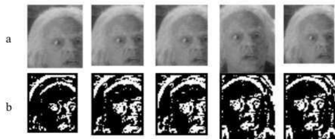
Figura 2.17: (a) Candidati che sono stati riconosciuti come volti (b) mappe dei bordi di tali candidati.
