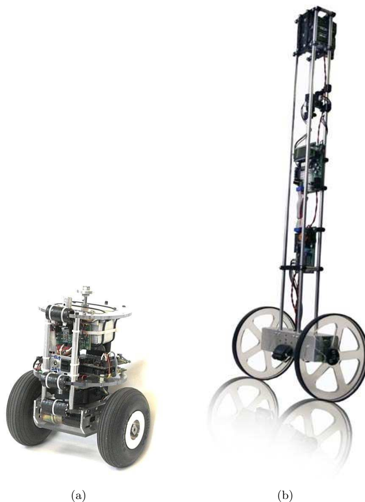
Figura 2.4: Robot bilanciati realizzati per lo studio di controllori classici: (a) nBot, 2001 (b) Balbot, 2005
