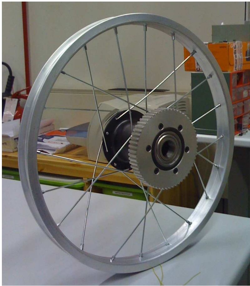
Figura 4.6: Cerchio, mozzo e puleggia assemblati
