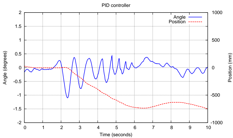
Figura 8.8: Controllore PID: reazione ad una sollecitazione esterna
