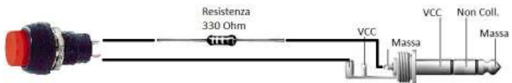
Figura 1.15: Schema di collegamento del cavo
