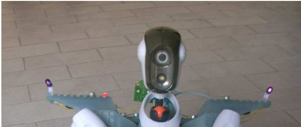
Figura 3.4: I led infrarossi montati sulle spalle del robot.
