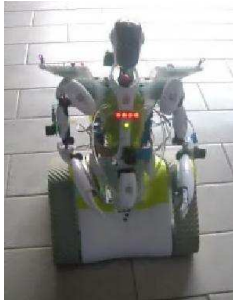
Figura 4.1: Led indicativi sul robot.
